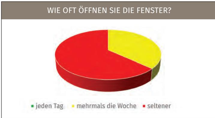
Bild 6: Fensterlüftung in mechanisch belüfteten Mehrfamilienhäusern (Dänemark)
